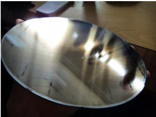
Cela vous donne une idée de la taille des têtes au passage... Notez que la tête d'un disque dur survole le plateau à moins de 10 nanomètres. Seagate a une belle allégorie à ce sujet : « *la tête d'un disque dur est l'équivalent d'un Boeing 747 volant à 800 fois la vitesse du son au-dessus d'une plaine irlandaise à quelques centimètres du sol en comptant la quantité de brins d'herbe...* ».
