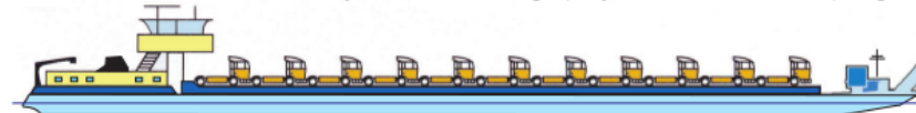
Roll on - Roll off (RO-RO), capacité 2 500 t à 5 000 t, longueur 143 m à 185 m
