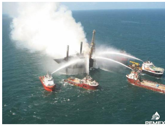
Figura 2.302 Trabajos de enfriamiento de las estructuras de las plataformas Usumacinta y Kab-101
