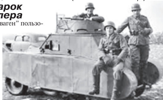
Бутафорский танк, построенный на базе “кюбельвагена”, получил наименование “Тип 823”. За счёт высокой скорости передвижения иногда даже наводил ужас на пехоту противника
