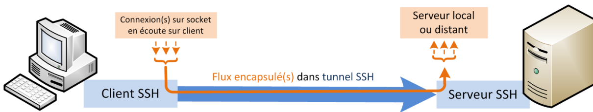
FIGURE 1 – Schéma d'une redirection sur le client SSH
