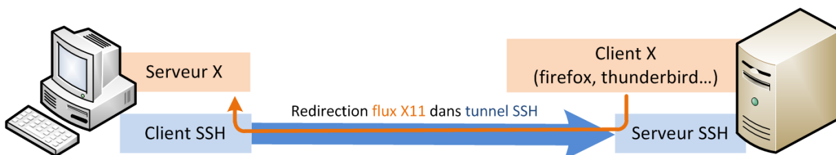
FIGURE 3 – Schéma d'une redirection X11 via SSH
