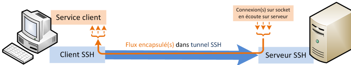
FIGURE 2 – Schéma d'une redirection sur le serveur SSH
